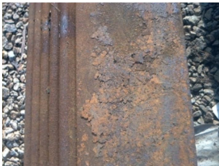
Carepa de laminação destruída
