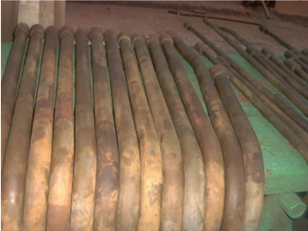
Corrosão em tubos
